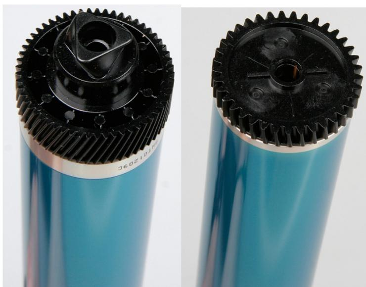
5. На ведущей шестерне 57 зубьев, заземляющий контакт барабана находится со стороны шестерни с меньшим количеством зубьев(узкая с более крупным зубом).
